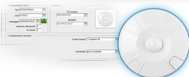
Tecnoalarm informa della **disponibilità** del rivelatore a infrarosso passivo da soffitto **IRSPACE BUS**, completamente gestibile tramite **RSC<sup>®</sup>** per impianti filari. Codice: **F102IRSPACEBUS**. Ricordiamo che è disponibile anche la sua versione equivalente con tecnologia radio, l'**EV IRSPACE BWL**, recentemente certificato **EN 50131** da **IMQ**.
